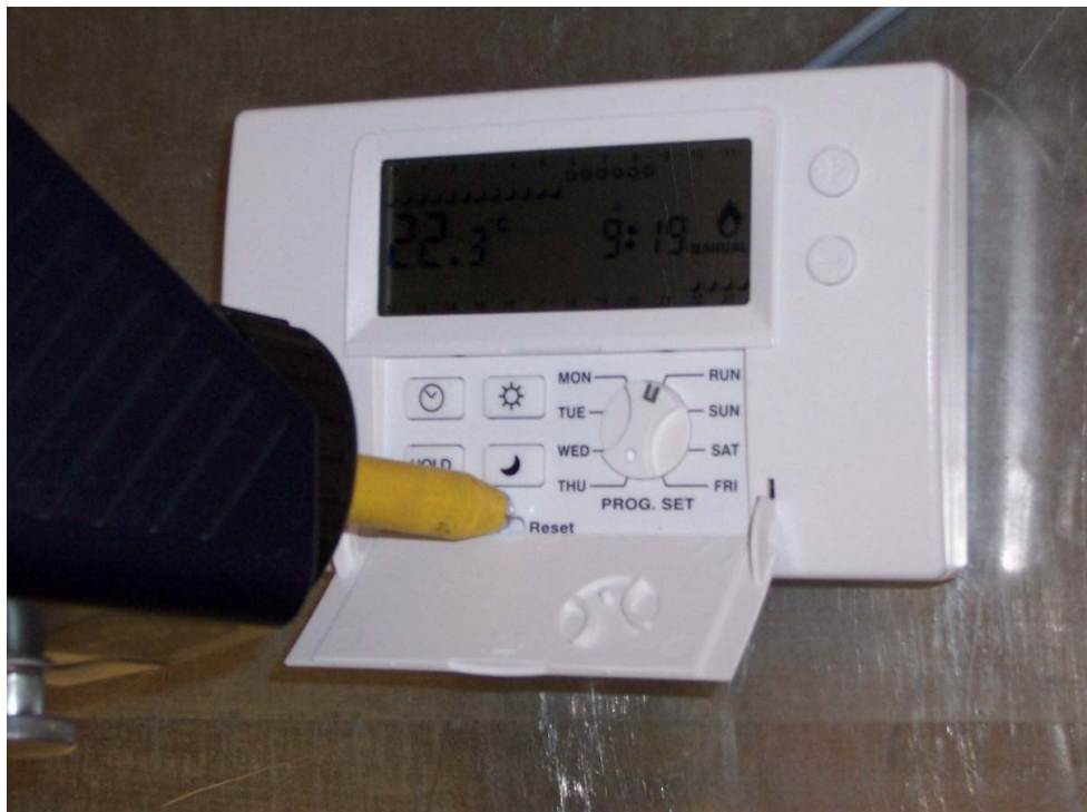
Bild 12. Störfestigkeit, Entladungen statischer Elektrizität [immunity, ESD]
