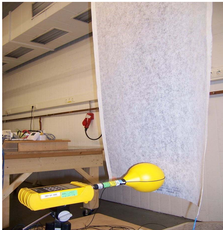
Bild 6. EMF an Heizbahn
