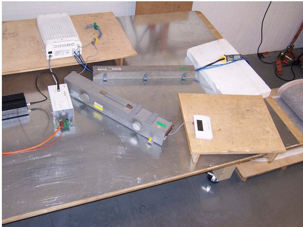
Bild 7. Störfestigkeit, HF-Einströmung [immunity, injected RF currents]
