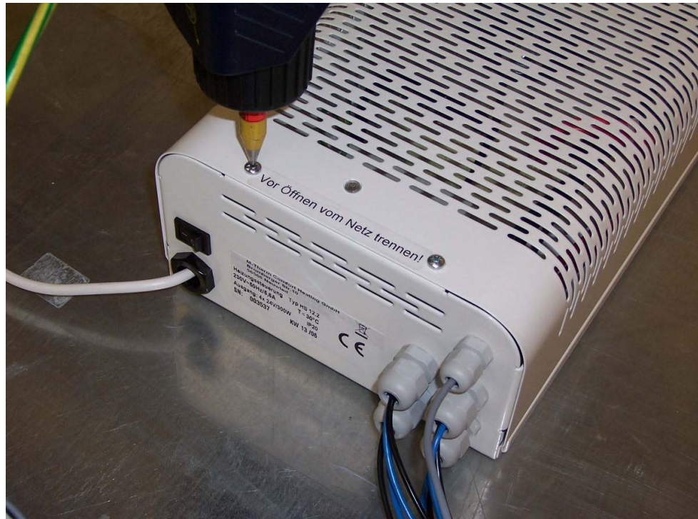
Bild 13. Störfestigkeit, Entladungen statischer Elektrizität [immunity, ESD]
